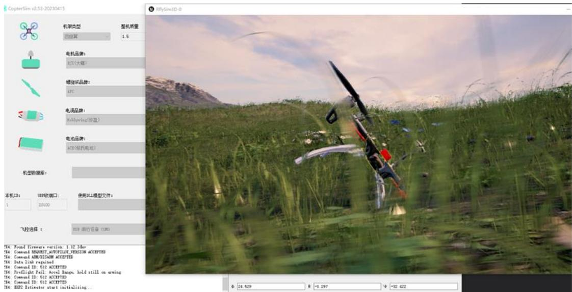
这种修改方式不可行，因为这个 200 个 step 的延迟，总共才  $200 \times 0.001 = 0.2$  秒。因为 px4\_simulink\_app 程序是上电就开始运行的，因此相当于上电之后，过一下就输入了控制指令，变成满油门状态了。这种情况下，飞控还没初始化完毕，滤波器触发发散状态，没有得到准确的位姿信息。
